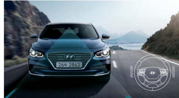
하이빔 보조 (LED 헤드램프 적용시)\_야간에 상황등을 켜고 주행하는 중 맞은편 또는 앞쪽에 차량이 있을 경우 헤드램프를 하향등으로 전환하여 잦은 상황등 조작에 따른 불편함을 줄여주고 운전차량 및 상대차량이 안전하게 주행할 수 있도록 도와줍니다.
