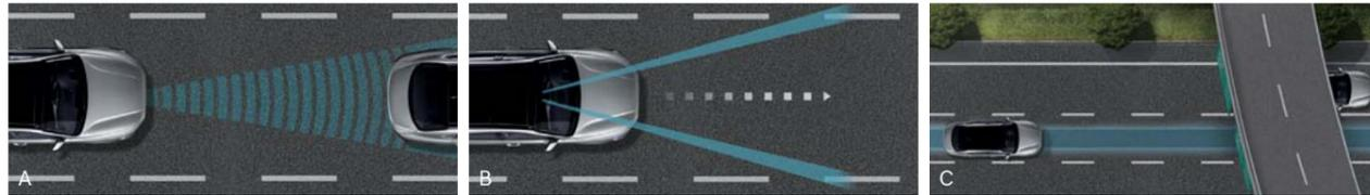
고속도로 주행지원 시스템\_고속도로 주행 시 앞차와의 차간거리, 차선 정보, 내비게이션을 이용한 제한속도 정보 등을 종합적으로 활용하여 차속 및 차로 중앙 주행을 보조하는 시스템입니다. 장거리 주행이나 정체 상황에서 브레이크나 엑셀을 밟을 필요가 없고, 스티어링 휠의 조정까지 보조해주어 편안한 주행이 가능합니다.
