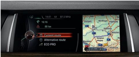
**내비게이션 시스템 프로페셔널** 화면 분할 기능이 있는 10.2" LCD 컬러 디스플레이(메인창과 보조창), DVD 드라이브 내장 라디오 프로세서, 오디오 파일을 위한 20GB 하드디스크, 실시간 교통 정보와 커넥티드 드라이브 서비스를 포함합니다. iDrive 컨트롤러는 센터 버튼과 8개의 즐겨찾기 버튼이 있으며 직관적으로 조작할 수 있습니다. 맵 디스플레이는 위성 이미지를 배경으로 3D 광학을 사용합니다. 선택된 관심 지역은 실제와 같은 스타일로 표시됩니다.
