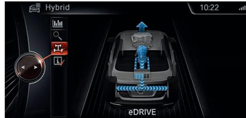
전기 구동 ECO PRO 모드를 **드라이빙 익스피리언스 컨트롤** 스위치로 활성화하면, 40kW 전기모터를 이용해 순전히 전기의 힘만으로 최대 3~4km의 거리를 주행할 수 있습니다. 또한 이 모드에서는 운전자가 가속 페달에서 발을 떼면 변속기가 맨전으로 유입되는 구동력을 차단하고 엔진을 정지시킵니다. 따라서 160km/h 이하의 속도에서 거의 아무런 소음도 없이 활주할 수 있습니다. 콤포트 모드에서는 최고 80km/h 이하의 속도에서 코스팅 기능이 작동합니다.
