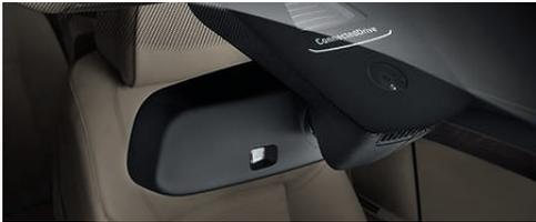
**레인 센서** 비가 오거나 날이 어두워질 때 최적의 시야를 보장해주는 자동 헤드라이트 작동 기능을 포함합니다. 강우량에 맞춰 윈드스크린 와이퍼 동작 속도를 조절하고, 필요에 따라 하향 전조등을 자동으로 켜줍니다.
