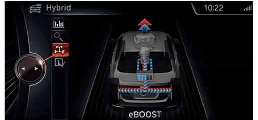
**부스트 기능** 추월을 하는 등의 상황에서 전기모터의 파워로 엔진을 지원하여 매우 역동적인 가속을 실현합니다. 컨트롤 디스플레이의 그래픽은 전기모터의 부스트 기능이 활성화되었음을 보여줍니다. 이 시스템은 브레이크 에너지 재생 장치가 저장한 에너지를 사용합니다.
