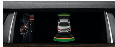
**주차 거리 경보 기능(PDC)** 전방과 후방에 제공되며, 좁은 곳에서도 손쉽게 주차 및 방향 전환을 하도록 돕습니다. 차가 장애물과 가까워지면 경고음 및 컨트롤 디스플레이 상의 시각적 표시로 알려줍니다.
