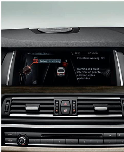
**드라이빙 어시스턴트** 카메라 기반의 차선이탈 경고장치와 접근 경고 장치를 결합했습니다. 이 시스템은 약 70km/h 이상의 속도에서 의도하지 않은 차선 이탈이 감지된 경우 스티어링 휠을 가볍게 진동시켜 운전자에게 경고를 보냅니다. 접근 경고 장치는 전방에 있는 차량과 보행자를 감지하고 잠재적 충돌 위험을 운전자에게 경고하는 동시에, 필요에 따라서 브레이크도 작동시킵니다.
