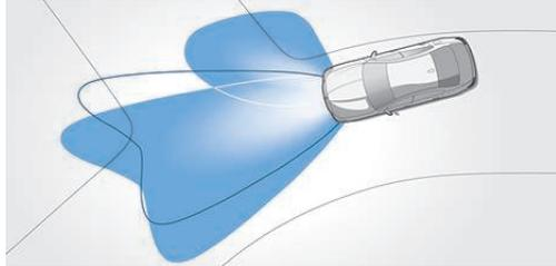
**어댑티브 헤드라이트**, 시내 및 고속 도로를 위한 가변 광선 분배 기능을 내장했습니다. 상향등과 하향등을 자동으로 전환하는 BMW 셀렉티브 빔(눈부심 방지 하이빔 어시스턴트)과 바이जे는 기술로 전방 도로를 최적으로 비춥니다. 코너링 라이트는 심지어 차량이 정지해 있을 때에도 스티어링 휠을 정해진 각도 이상 돌리거나 방향지시등을 켜면 들어옵니다.
