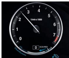
**ECO PRO 모드 내장 드라이브 익스피리언스 컨트롤 스위치** 센터 콘솔에 위치하며, 한번의 버튼 터치로 귀하기 원하는 모드를 선택할 수 있습니다. 콤포트 모드에서는 엔진과 변속기가 기본 세팅을 유지하지만, ECO PRO 모드를 선택하면 효율성 지향으로 변경되고, 스포츠 모드를 선택하면 더욱 다이내믹한 드라이빙에 초점이 맞춰집니다. 현재 활성화된 모드는 속도계 아래에 표시됩니다.
