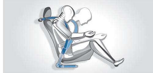
운전자와 앞좌석 승객을 위한 **BMW 안전 보호 시스템**, 3점식 시트 벨트, 벨트 텐서너, 벨트장력 제한장치로 구성되어, 충돌 시 가장 효과적인 보호 효과를 보장합니다. 뒷좌석 시트 벨트의 경우에는 잘못된 체결을 방지하기 위해 버클에 표시가 되어 있습니다.
