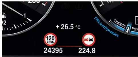
**제한 속도 안내 기능** 추월 금지 인디케이터가 내장되어 있어, 제한 속도 및 추월 금지 정보를 감지하고 인스트루먼트 클러스터의 디스플레이 또는 BMW 헤드업 디스플레이에 표시합니다. 이 장치를 사용하려면 내비게이션 시스템 프로세서별이 설치되어 있어야 합니다.
