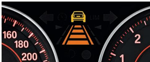
**방지/출발 가능 내장 액티브 크루즈 컨트롤** 레이더 기반의 브레이크링 기능 내장 접근 경고장치를 포함합니다. 이 시스템은 미리 선택한 차간거리를 유지하고 자동으로 속도를 조절하는데, 완전히 멈출 때까지 감속도 하고, 이어서 선택한 속도까지 다시 가속도 합니다.
