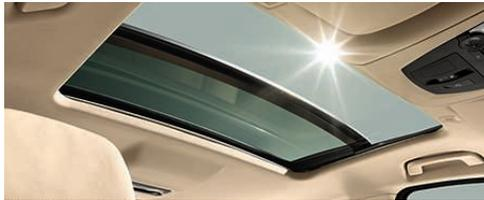
**글라스 루프** 손 갈음으로 조작 가능한 슬라이딩 시스템, 전동 조절식 플로팅 헤드라이너, 트림 랠리스, 컴포트 개폐 기능으로 개인 기호에 맞춰 공기 흐름을 조절하여 실내 기후를 쾌적하게 할 수 있습니다. 자동 개폐식 통합 윈드 디플렉터는 소음을 줄여 안락함을 높여줍니다. 이 글라스 루프는 리모컨 키를 이용해 외부에서도 조작이 가능합니다.
