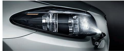
**헤드라이트 세척 장치** 어떠한 날씨에도 최적의 전조등 광도를 보장합니다. 윈드스크린 워셔 기능을 작동하면 윈드스크린과 함께 헤드라이트도 자동으로 세척됩니다.
