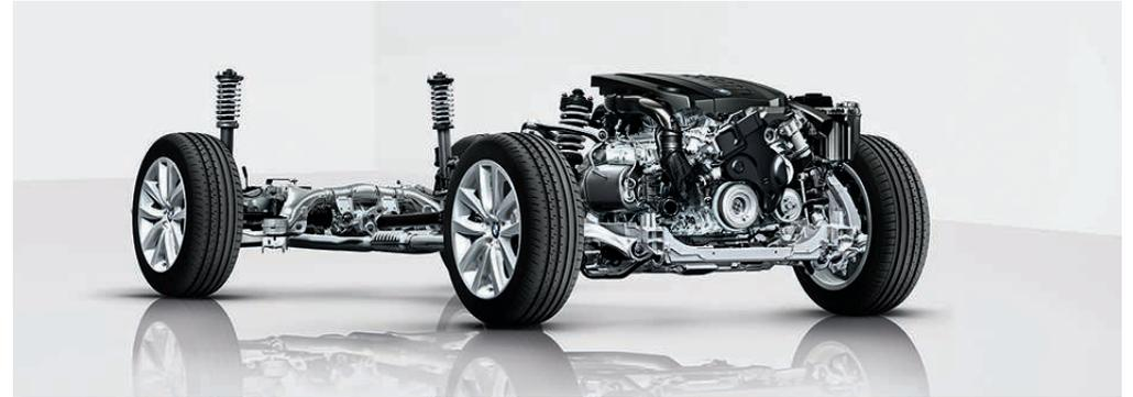
후륜 구동 차량에 옵션으로 제공되는 **인테그럴 액티브 스티어링**은 후륜의 조향 기능과 전륜의 기본 조향비를 결합했습니다. 60km/h 이하의 속도에서는 뒷바퀴가 앞바퀴의 반대 방향으로 틀어져, 휠베이스가 짧아진 듯한 효과가 발생하고 조종성과 민첩성이 향상됩니다. 반면에 약 60km/h부터는 뒷바퀴가 앞바퀴와 동일한 방향으로 조향되어, 휠베이스가 길어진 듯한 느낌이 나고 주행 안정성과 인락성이 높아지는데, 이는 특히 빠르고 갑작스럽게 차선 변경을 해야 하는 경우에 유용합니다.
