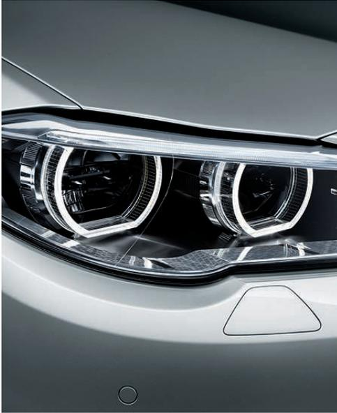
**어댑티브 LED 헤드라이트** BMW 셀렉티브 빔(눈부심 방지 하이빔 어시스턴트), 코너링 라이트, 어댑티브 라이트를 포함합니다. 태양광과 유사한 밝은 빛으로 전방 도로를 최적으로 비추고, 가시성을 높여주고, 야간 운전시 피로감을 줄여줍니다. 4개의 LED 라이트 링이 독특한 외관을 연출합니다.
