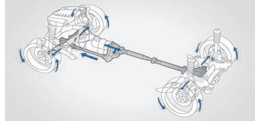
지능형 사륜구동 시스템 **xDrive**, 까다로운 도로 조건을 만나도 항상 완벽하게 적응하고 필요한 추가적인 트랙션을 발휘합니다. xDrive와 다이내믹 스테빌리티 컨트롤(DSC)이 있으면 귀하의 차량은 언제나 경로를 벗어나지 않고 안정적으로 달릴 수 있습니다. xDrive는 구동력을 앞뒤 차축 간에 순식간에 배분하여 최적의 로드 홀딩을 보장하며, 이를 통해 트랙션, 방향 안정성, 주행 안전성 같은 사륜구동 장치의 혜택을 BMW의 전형적인 민첩성과 함께 제공합니다.
