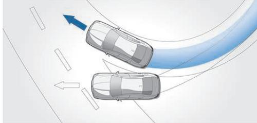
**다이내믹 스테빌리티 컨트롤(DSC)**, 센서를 이용해 운전 상태를 지속적으로 모니터링하고, 필요에 따라 엔진 및 브레이크 관리 시스템에 개입하여 방향 안정성과 트랙션을 최적화합니다. 따라서, 까다로운 도로 조건에서도 차를 손쉽게 통제할 수 있고, 주행 안전성을 적극적으로 향상시켜 결과적으로 드라이빙의 즐거움이 더욱 높아집니다.
