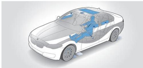
**액티브 프로텍션**, BMW 커넥티드드라이브가 제공하는 예방적 탑승자 보호 시스템으로, 위험 상황이 발생하면 안전 벨트의 프리텐션 기능을 실행하고, 시트를 직립 위치로 이동시키고, 윈도우를 닫습니다. 충돌 발생 후에는 자동으로 브레이크를 잡아 차를 정지 시킵니다. 또한, 어텐션 어시스턴트(Attention Assistant)는 운전자가 피로감을 느끼고 있는지 가려내는 장치로, 스티어링 휠 조작을 분석해 이상 행동이 감지되면 컨트롤 디스플레이에 휴식을 취하라는 권고 메시지를 띄웁니다.
