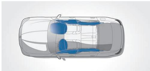
**운전석 및 동반석 에어백**, 정밀하게 조화를 이루며 작동하는 핵심 안전 기능 중 하나입니다. 운전석 및 동반석 에어백, 커튼식 헤드 에어백, 프론트 시트 등받이에 내장된 사이드 에어백이 공조하여 민일의 충돌 사고 시 귀하와 승객을 효과적으로 보호합니다.
