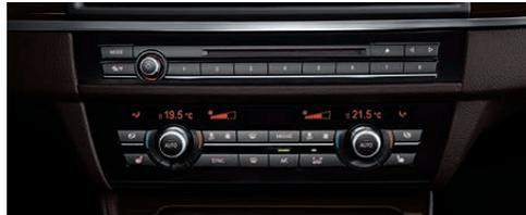
**2존 자동 에어컨** 자동 풍량 온도 컨트롤을 제공하며, 운전석과 동반석을 개별적으로 설정하는 것이 가능합니다. 뒷좌석 통풍구, 마이크로 필터, 김서림 센서, 최대냉방(Max-Cool) 버튼, 주차 환기 기능을 포함합니다.
