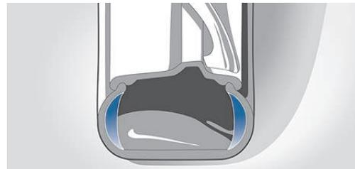
**런플랫 타이어**, 사이드 월 부위가 보강되어 있어 펑크가 나도 타이어가 림에서 분리되지 않기 때문에 가까운 정비소까지 안전하게 이동할 수 있습니다. **타이어 압력 디스플레이**, 타이어 압력을 항상 운전자에게 정확하게 알려줄 뿐만 아니라 공기압 상실도 경고해 줍니다. 센서를 이용하여 각각의 타이어 압력을 모니터링하고, 데이터를 컨트롤 유닛으로 무선 전송하여, 공기압이 급격히 떨어지는 것뿐만 아니라 서서히 빠지는 것도 디스플레이를 통해 보여줍니다.
