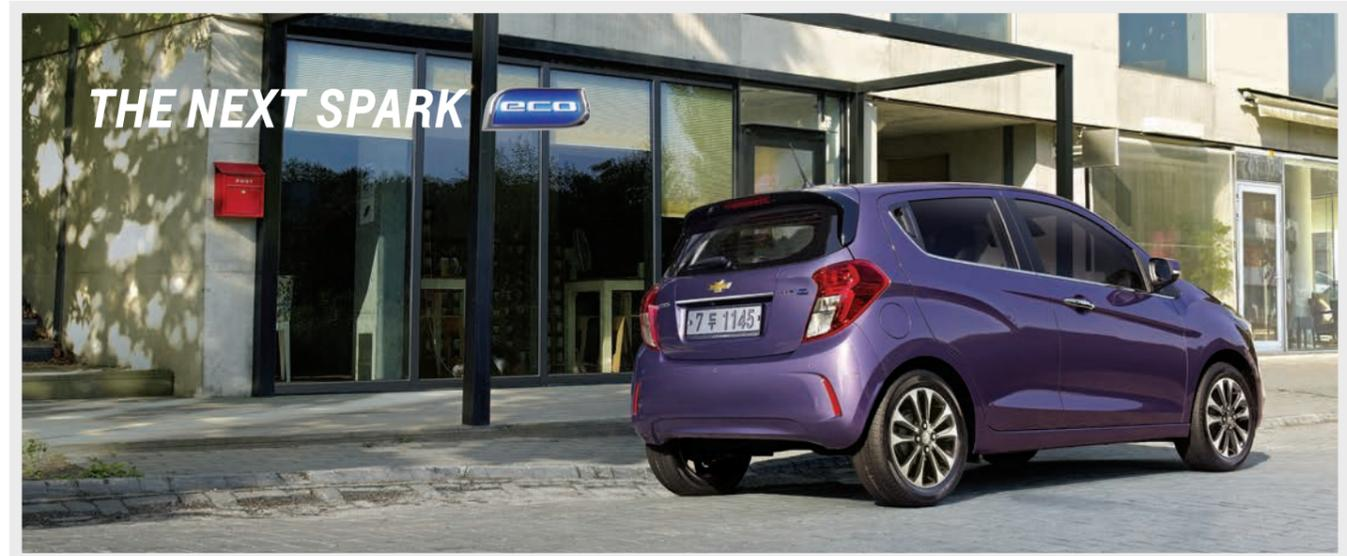
10 가솔린(수동 5단) - 엔진 배기량 : 999cc 엔진최고출력 : 75/6,500 ps/rpm 엔진최대토크 : 9.7/4,500 kgm/rpm 복합연비(km/l) : 15.2 (도시연비 : 14.5, 고속도로연비 : 16.0) 경형 CO2배출량 : 109 g/km
