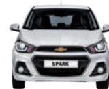
C-TECH - 엔진 배기량 : 999cc 엔진최고출력 : 75/6,500 ps/rpm 엔진최대토크 : 9.7/4,500 kgm/rpm 복합연비(km/l) : 15.4 (도시연비 : 14.6, 고속도로연비 : 16.4) 경형 CO2배출량 : 107 g/km
