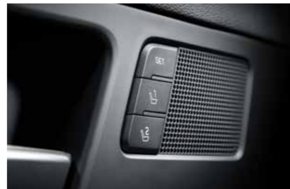
스마트폰 무선충전 / 운전석 자세 메모리 시스템(IMS)
