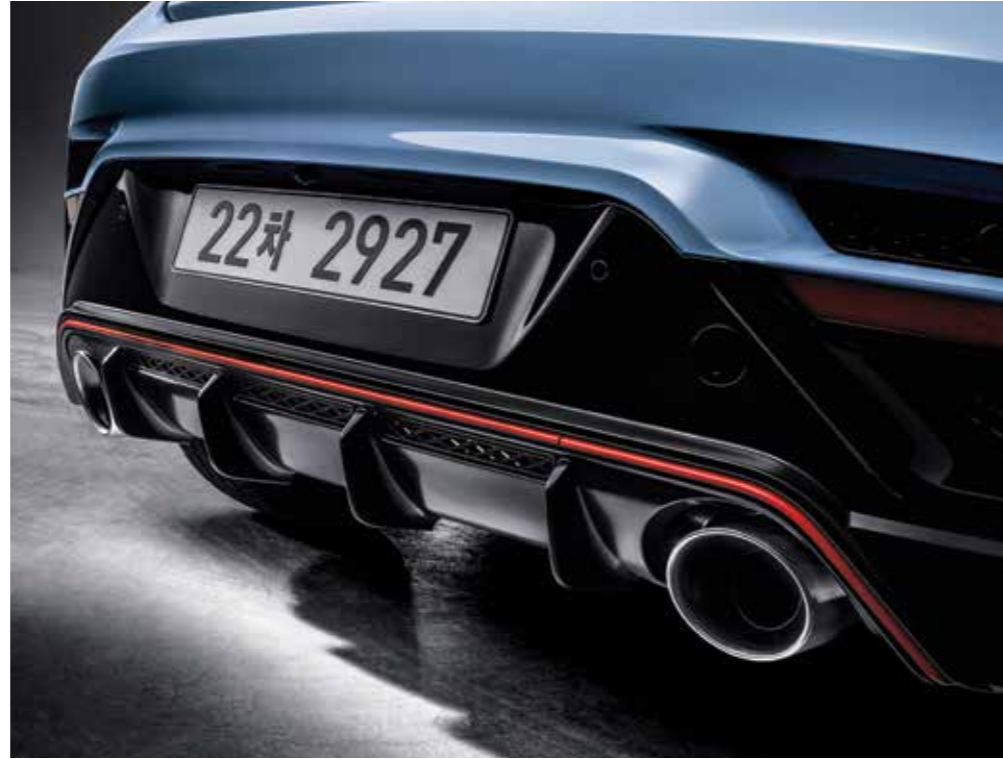
대형 에어핀 적용 리어 디퓨저 4개의 대형 에어핀이 적용된 리어 디퓨저로 공력을 개선하고, 더욱 스포티한 벨로스터 N만의 캐릭터를 구축했습니다.
