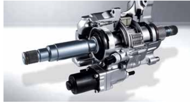
N 코너 카빙 디퍼렌셜 (N Corner Carving Differential) 코너링 주행 시 좌우 바퀴의 구동력을 전자적으로 제어/배분하여 미끄러짐 없는 가속이 가능합니다.
