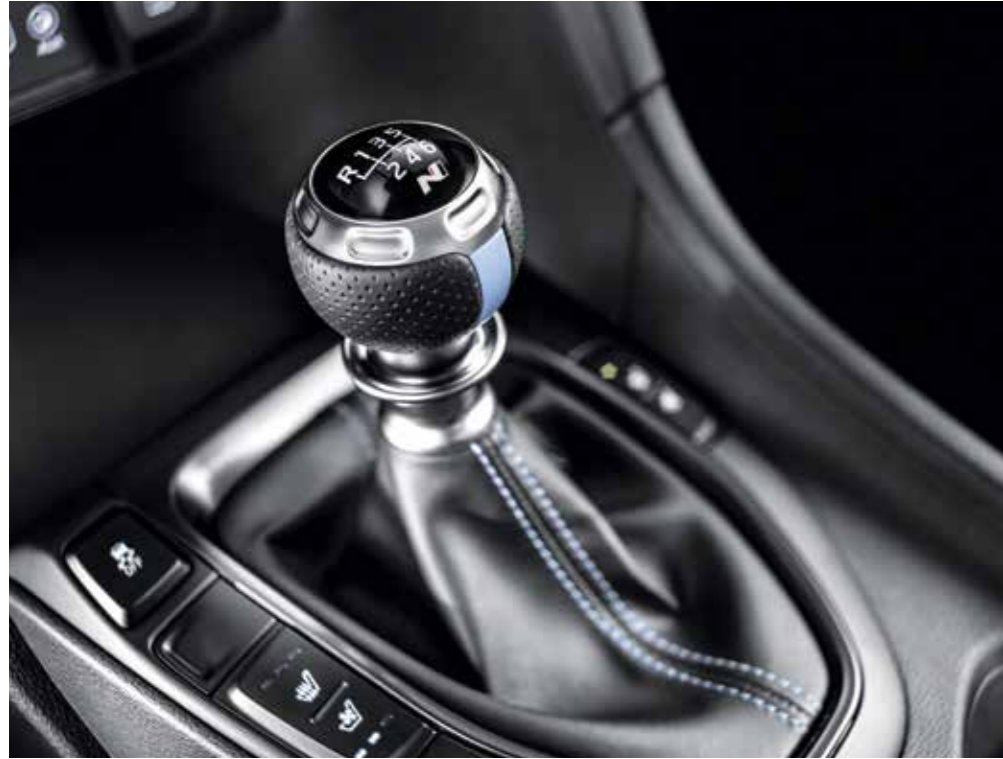
N 전용 6단 수동 변속기 & 레브매칭 변속 시 RPM을 동기화하는 레브매칭 시스템으로 변속충격을 최소화하고, 다이내믹한 변속감을 전달합니다.
