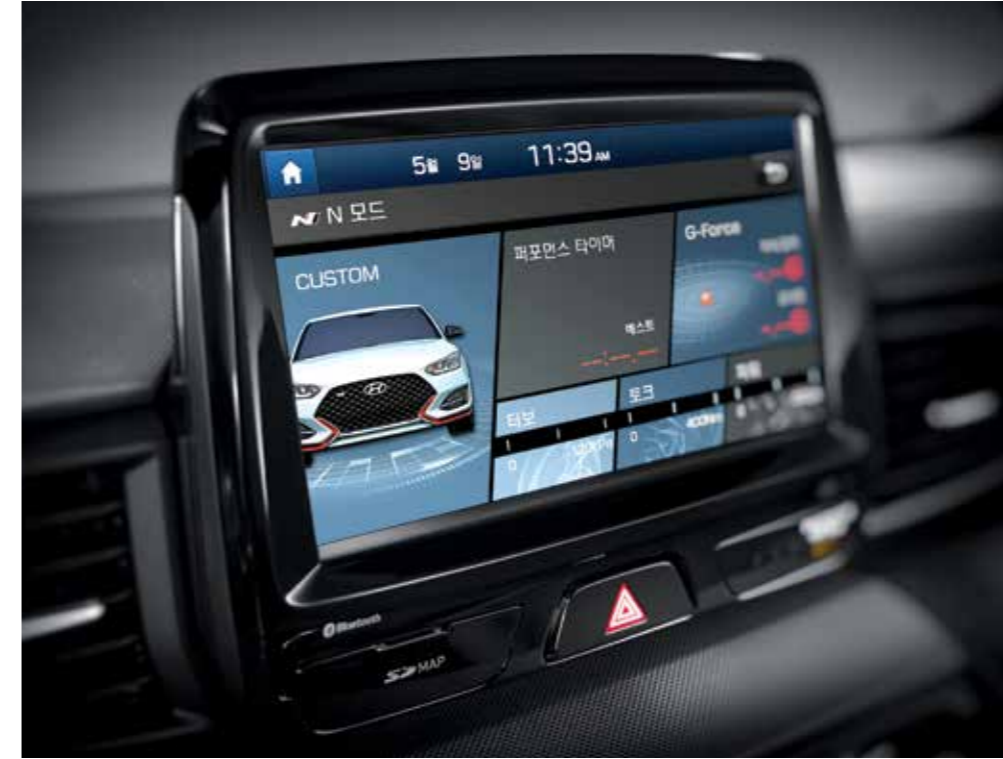
N 그린 컨트롤 시스템 주행 특성을 파워트레인/샤시 항목별로 설정하고, 출력/토크/중력가속도 등의 정보를 실시간으로 인지할 수 있습니다.
