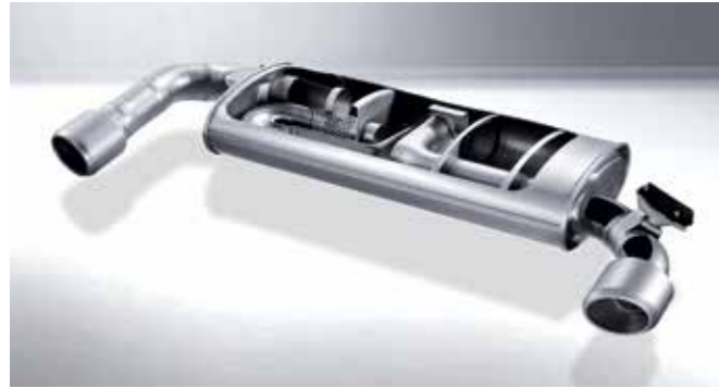
능동 가변 배기시스템 (Variable Exhaust Valve) 배기 파이프의 형상과 전자식 가변 밸브를 이용하여 운전상황에 맞게 정속하거나 스포티한 배기음을 선사합니다.
