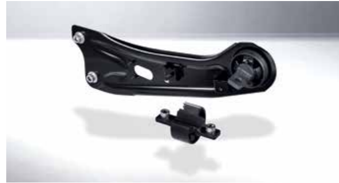
이중 재질 부시 (DCB, Dual Compound Bush) 서스펜션과 차량을 연결하는 고무를 전후/상하 방향에 따라 다른 재질을 사용하여 조종안정성과 소음진동 성능을 동시에 만족시킵니다.
