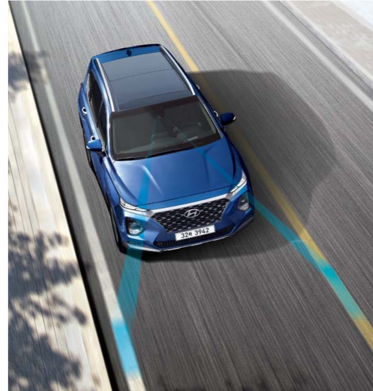
전방 충돌방지 보조 / 전방 충돌 경고 선행 차량과의 충돌 위험이 감지될 경우 운전자에게 이를 경보하고, 필요 시 브레이크 작동을 보조합니다.
