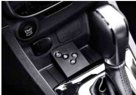
인텔리전트 스마트카드 시스템 (키리스 엔진시동/오토 클로징/리퀘스트 버튼)
