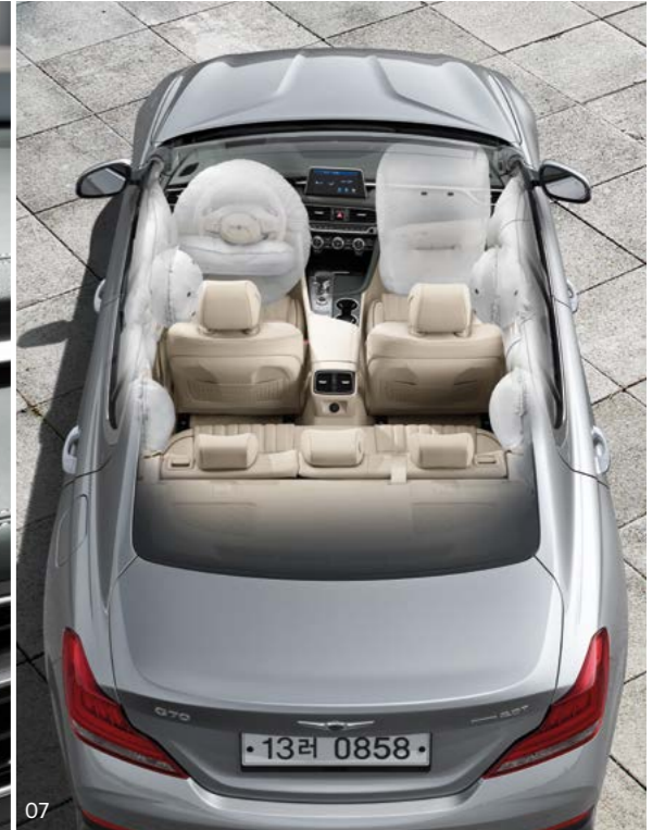
07. 9 에어백 시스템 _ 운전석/동승석에는 탑승자의 위치와 체중, 충돌 정도에 따라 팽창 정도와 시점을 제어해주는 어드밴스드 에어백을 적용하였습니다. 운전석 무릎 에어백, 앞/뒤 사이드 에어백과 전복 대응 커튼 에어백까지 총 9개의 에어백으로 상해를 최소화합니다.
