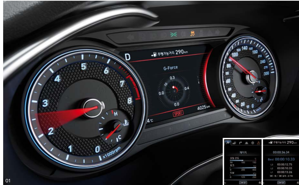
01. 7인치 TFT LCD 클러스터 _ 엔진오일 온도 게이지, 토크 게이지, 터보 부스터 게이지, 베스트 랩과 최근 3개까지 랩타임을 보여주는 랩타임어, 현재의 상/하/좌/우 G값(중력가속도)을 알려주는 G-Force가 표시됩니다. 고성능 드라이빙의 쾌감이 차별화된 콘텐츠를 통하여 더욱 극대화됩니다.
