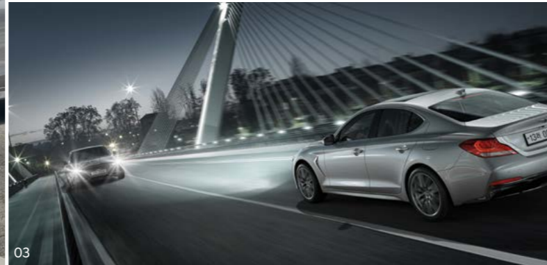
03. 하이빔 보조 _ 야간 주행 시 마주 오는 차량의 전조등 불빛 및 주변 조도를 감지하여 헤드램프를 상향등에서 하향등으로 자동 전환시킴으로써 운전 차량 및 상대 차량이 보다 안전하게 주행할 수 있도록 보조합니다.
