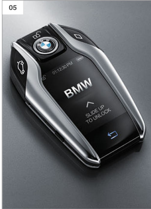
[ 05 ] BMW 디스플레이 키는 차량 상태에 관한 다양한 정보를 보여주고, 통합 터치 스크린을 통해 일부 기능을 제어할 수 있습니다.
