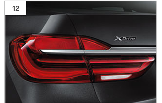
[ 12 ] LED 리어 라이트는 2부분으로 분할되어 미등, 제동 등, 방향지시등, 후진등에 LED 기술이 적용됩니다.
