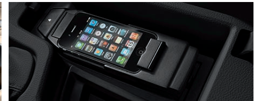
스마트폰 연결 기능이 확장된 컨비니언스 텔레포니(Convenience Telephony) 블루투스 호환 휴대폰과 차량 무선으로 연결할 수 있습니다. 핸드프리 키트도 포함합니다. 스냅인 어댑터를 이용해 외부 안테나를 연결하면 음질을 더욱 높일 수 있습니다. USB 인터페이스 내장 핸드프리 키트 블루투스 호환 휴대폰을 무선으로 연결할 수 있고, USB 인터페이스를 통해 적합한 오디오 장비(MP3 플레이어 등)를 연결할 수 있습니다.
