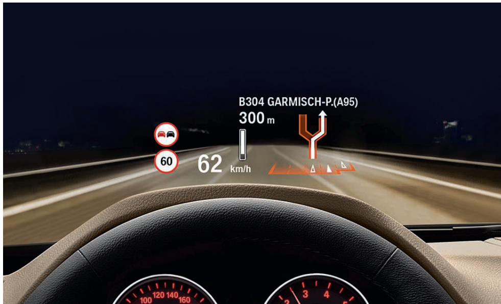
BMW 헤드업 디스플레이 풀컬러이고, 기능 확장형 인스트루먼트 클러스터를 포함합니다. 주행속도 같은 운행 관련 정보를 운전자의 시선 상에 직접 반사시켜 보여줍니다. 그리고 정보를 풀컬러로 제공하기 때문에, 서로 다른 다양한 심도와 정보를 빠르고 정확하게 인식하기가 더욱 쉽습니다. 또한, 네비게이션 안내, 제한 속도 인포, 체크 컨트롤 기능, 엔터테인먼트 및 커뮤니케이션 리스트도 표시할 수 있습니다.
