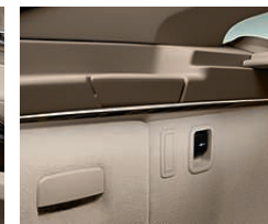
리어 백레스트 릴리스 기능 (수납 패키지에 포함) 트렁크에서 뒷좌석 등받이의 잠금을 해제하고 아래로 접어 내리면 거의 평탄한 적재면이 만들어집니다.
