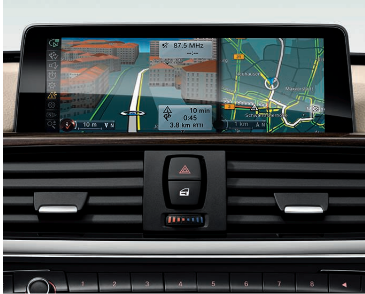
차세대 내비게이션 시스템 프로페셔널 고해상도 8.8" 디스플레이, DVD 체인저, 비모시기 버튼이 있는 iDrive 컨트롤러, 즐겨찾기 버튼, 오디오와 내비게이션 데이터 저장용 위한 내장형 하드디스크(20GB), 3D 지도 디스플레이를 포함합니다. 확장된 기능과 5.2" 인포 디스플레이를 갖춘 인스트루먼트 패널이 제공됩니다.
