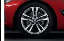
18" 경합금 휠 더블-스포크 스타일 397, 바이컬러 페릭 그레이 색상, 선반 가공 광택 마감, 8 J x 18, 225/50 R 18 타이어 장착.
