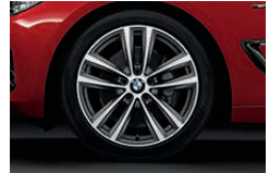
19" 경합금 휠 더블-스포크 스타일 466, 바이컬러 페릭 그레이 색상, 선반 가공 광택 마감, 앞뒤 다른 규격 타이어, 전륜에 8 J x 19, 225/45 R 19 타이어, 후륜에 9 J x 19, 255/40 R 19 타이어 장착.
