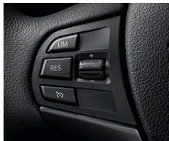
브레이킹 가능 내장 크루즈 컨트롤 운전자가 선택한 약 30km/h 이상의 속도를 저장하고 유지합니다. 심지어 내리막길에서도 작동하며, 다가오는 스티어링 휠로 조작합니다.
