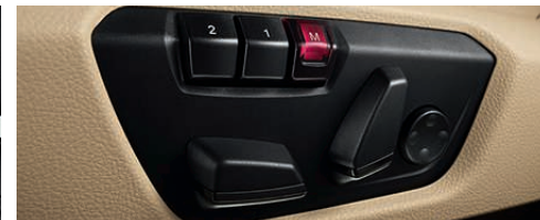
전동 시트 조절 장치 메모리 기능이 있어, 운전자는 자신이 원하는 시트와 아웃사이드 미러 세팅을 저장하고 불러올 수 있습니다(자동 주차 기능 포함). 림버 서포트 운전석 및 동반석에 제공됩니다. 높이와 깊이를 전동 조절하여 인체공학적으로 완벽한 시트 포지션을 구현할 수 있습니다.
