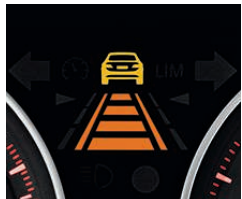
정지/출발 가능 내장 액티브 크루즈 컨트롤 레이더 기반 접근 경고기능과 브레이킹 기능을 포함합니다. 전방 차량을 고려하면서 운전자가 선택한 210km/h 이하의 속도를 자동으로 유지합니다. 이 시스템은 가다서다를 반복하는 교통 상황에서는 차를 완전히 정차시키고 적절한 시점에 자동으로 다시 출발시켜줍니다.
