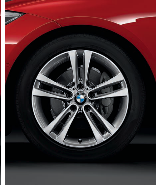
18" 경합금 휠 더블-스포츠 스타일 397 비이컬러 페릭 그레이 색상, 선반 가공 광택 마감, 8 J x 18, 225/50 R 18 타이어 장착.
