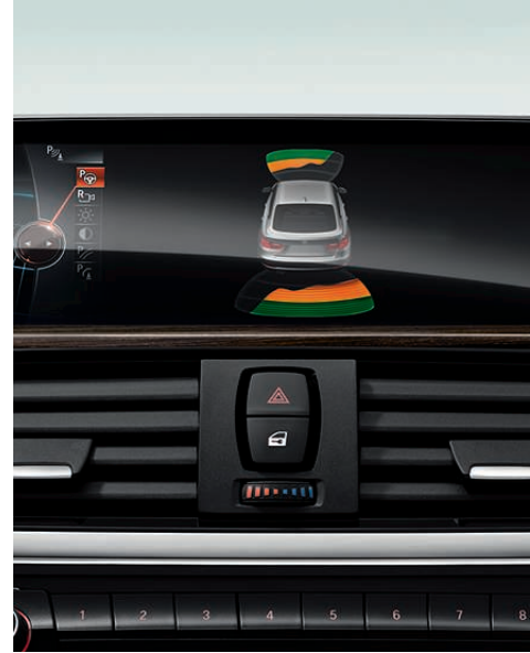
주차거리경보기능(PDC) 전방과 후방, 또는 후방에만 제공됩니다. 매우 좁은 곳에서도 손쉽게 주차 및 방향전환을 하도록 돕는 기능으로, 장애물과 가까워지면 경고음 및 컨트롤러 디스플레이 상의 시각적 표시로 알려줍니다.
