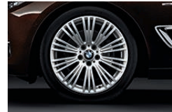
19" 경합금 휠 W-스포크 스타일 440, 선반 가공 광택 마감, 앞뒤 다른 규격 타이어, 전륜에 8 J x 19, 225/45 R 19 타이어, 후륜에 9 J x 19, 255/40 R 19 타이어 장착.
