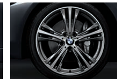
19" 경합금 휠 스타-스포크 스타일 407과 앞뒤 다른 규격의 런플랫 타이어, 전륜에 8 J x 19, 225/40 R 19 타이어, 후륜에 8.5 J x 19, 255/35 R 19 타이어가 장착됩니다.
