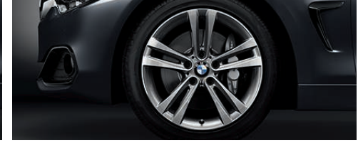
18" 경합금 휠 더블-스포츠 스타일 397 비아컬러 페릭 그레이 색상, 고광택 처리, 런플랫 타이어, 8 J x 18, 225/45 R 18 타이어가 장착됩니다.
