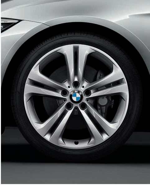
19" 경합금 휠 더블-스포츠 스타일 401 앞뒤 다른 규격의 런플랫 타이어, 전륜에 8 J x 19, 225/40 R 19 타이어, 후륜에 8.5 J x 19, 255/35 R 19 타이어가 장착됩니다.
