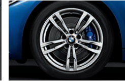
18" M 경합금 휠 더블-스포크 스타일 441 M 과 앞뒤 다른 규격의 런플랫 타이어, 전륜에 8 J x 18, 225/45 R 18 타이어, 후륜에 8.5 J x 18, 255/40 R 18 타이어가 장착됩니다.
