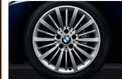
고광택 18" 경합금 휠 멀티-스포크 스타일 416 과 런플랫 타이어, 8 J x 18, 225/45 R 18 타이어가 장착됩니다.
