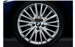
19" 경합금 휠 멀티-스포크 스타일 399와 앞뒤 다른 규격의 런플랫 타이어, 전륜에 8 J x 19, 225/40 R 19 타이어, 후륜에 8.5 J x 19, 255/35 R 19 타이어가 장착됩니다.
