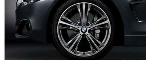
19" 경합금 휠 스타-스포츠 스타일 407 앞뒤 다른 규격의 런플랫 타이어, 전륜에 8 J x 19, 225/40 R 19 타이어, 후륜에 8.5 J x 19, 255/35 R 19 타이어가 장착됩니다.
