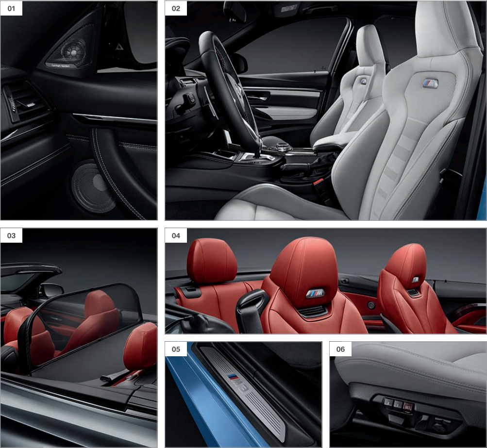
【 01 】 하만 카돈 서라운드 사운드 시스템은 9채널 600와트 디지털 앰프, 맞춤형 이퀄라이저, 섀터 스피커를 포함한 16개의 리우드스피커를 제공합니다. 【 02 】 M 시트는 버킷 스타일 캐릭터, 입체형 헤드레스트, 몸을 완벽하게 지지하는 높은 사이드 볼스터, 등받이 내비 조절장치, 램버 서포트를 제공합니다. 【 03 】 두 개의 리어 시트는 최적의 편안함을 제공하고, 60:40 분할 접이식 등받이로 리지 컴파트먼트를 유연하게 사용할 수 있습니다. 【 04 】 M 시트의 조영식 M 심볼은 독특한 M 캐릭터를 강조하고 스포티한 특별함을 드러냅니다. 【 05 】 모델 표시가 각인된 전형적인 조영식 M 도어실 피니셔는 도어를 여는 순간 곧장 특별한 드라이빙을 더욱 가슴 실리게 합니다. 【 06 】 메모리 기능 내장 전동 시트 조절장치는 시트 높이, 등받이 각도, 시트 전/후 위치, 시트 각도를 조절하여 완벽하게 맞춰진 시트 포지션을 구현합니다.
