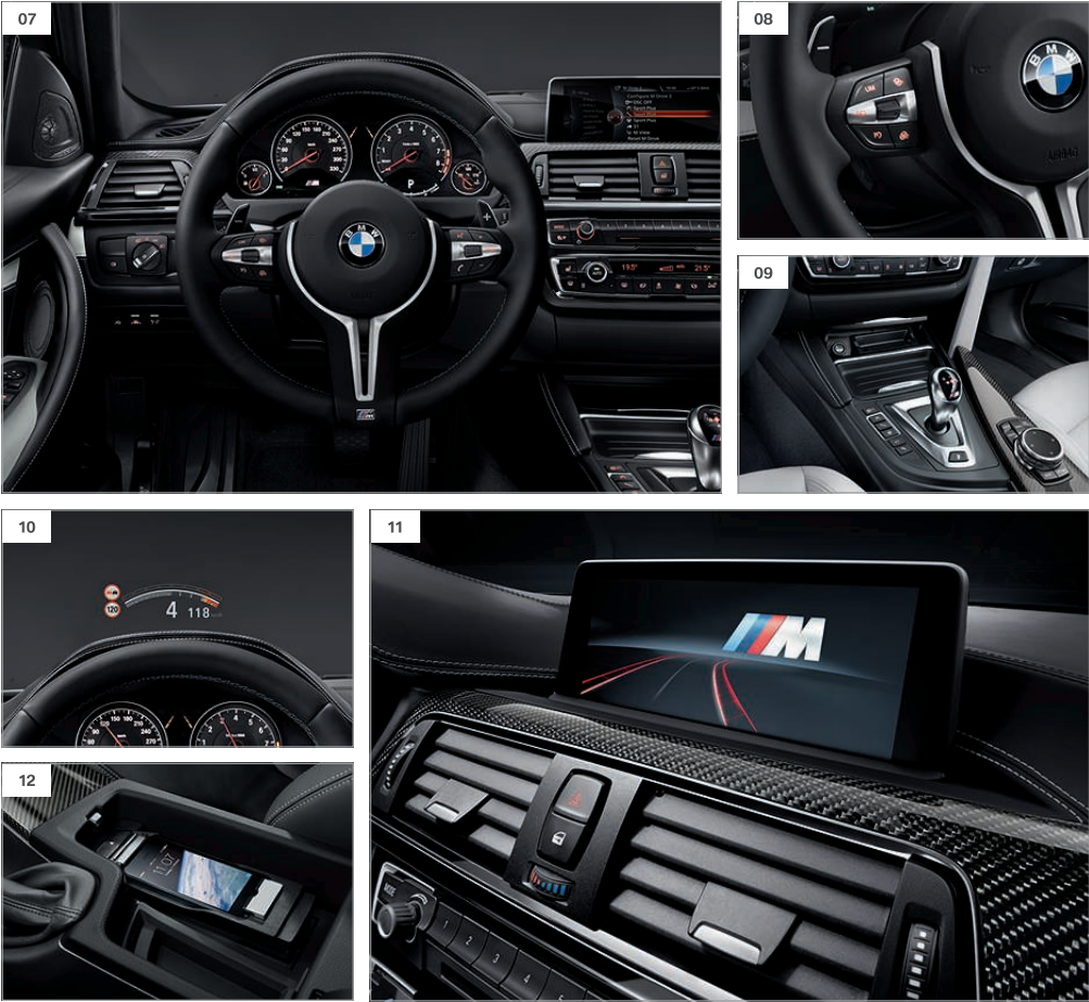
【 07 】 더블스프ોક 디자인의 M 가죽 스티어링 휠은 M 엠블럼, M 드라이버 버튼, 크롬 디테일, 칼라 콘트라스트 스티치를 제공합니다. 【 08 】 M 드라이버는 엔진, 섀시, 조향 특성, 변속기 특성을 조절하여 개인 취향에 맞는 차량 셋업을 제공합니다. 【 09 】 드라이버로직 내장 7인 M 듀얼 클러스터 트랜스미션은 트랙션이 최적화된 자동 기어 선택, 론치 컨트롤(Launch Control), 저속 주행 어시스턴스(Low Speed Assistance), 오토 스타트스톱 기능을 포함합니다. 【 10 】 M 전용 디스플레이를 내장한 BMW 헤드업 디스플레이는 운행 관련 정보를 최적화된 운전자 시야에 직접 투영해 보여줍니다. 【 11 】 네비게이션 시스템 프로세서널은 랩스프리트, USB 인터페이스, iDrive 터치 컨트롤러로 작동되는 DVD 드라이브 내장 라디오 프로세서널을 포함합니다. 【 12 】 스마트폰 연결 기능이 확장된 컴포트 텔레포니는 MP3 플레이어 또는 애플 아이팟/아이폰을 위한 핸드프리 컨트롤과 연결 기능을 포함합니다.
