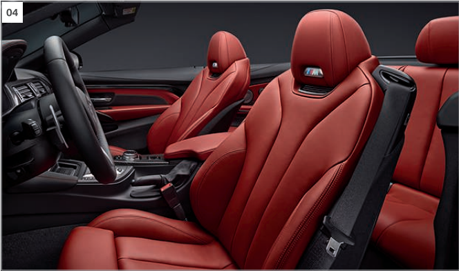
【 03 】 “바르겐” 호르는 사이드 라인과 스포티하고 평탄한 후면부로 높은 역동성과 최대한의 우아함을 동시에 표출합니다. 【 04 】 M 시트는 역동적인 주행시에도 완벽한 인체공학과 지지력을 제공합니다. 사진은 옵션 품목인 사키르 오렌지 폴 화인그레인 메리노 가죽으로 마감된 모습입니다. 【 05 】 M 경합금 휠은 스포티한 디자인이 특징으로 차량 중량 감소에 기여합니다. 19" M 경합금 휠 V-스프크 437 M, 랙쉬 디튼 규격의 타이어가 옵션으로 제공됩니다.
