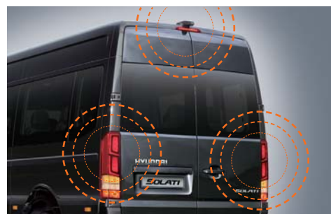
리어 콤비램프 및 급제동 경보시스템 (HAC), (디럭스 기본)
