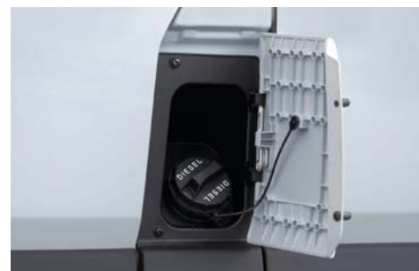
푸쉬오픈(Push-Open) 타입 연료 주입구 (운전석/조수석과 연계하여 Locking 기능)
